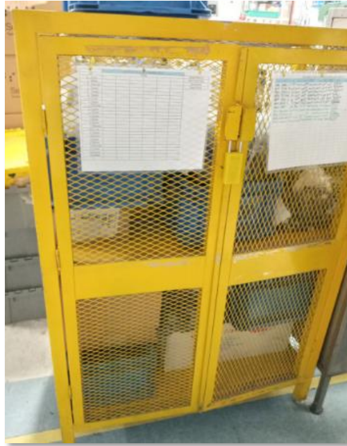
Figura 15. Rack de Material no Conformante
